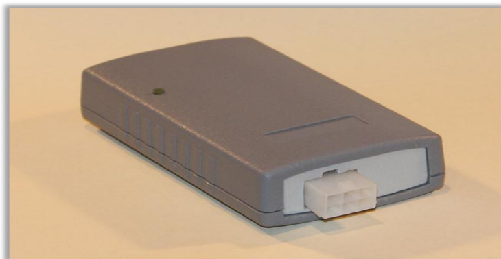
Рис. П.3.1 - Внешний вид передатчика информации по системе Bluetooth от датчиков скорости и расхода топлива к компьютеру Netbook
